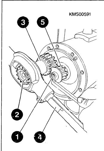
DISASSEMBLING 4-SPEED REDUCTION GEAR (TYPE TF 0 001 6....)
